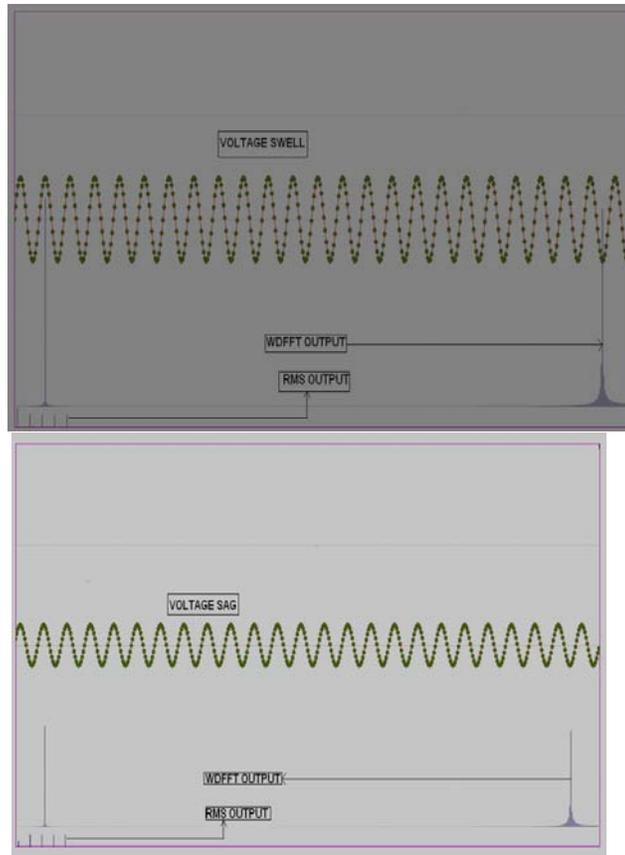
a)  $e(t) = A1 * \sin(\omega t) - A2 * U1*(t-T1)*U2*(t-T2)*\sin(\omega t)$  (Voltage sag)
